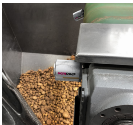
Zwei 60ml simalube schmieren die Lager der Umlenkrolle eines Förderbandes in der Kartoffelverarbeitung.
