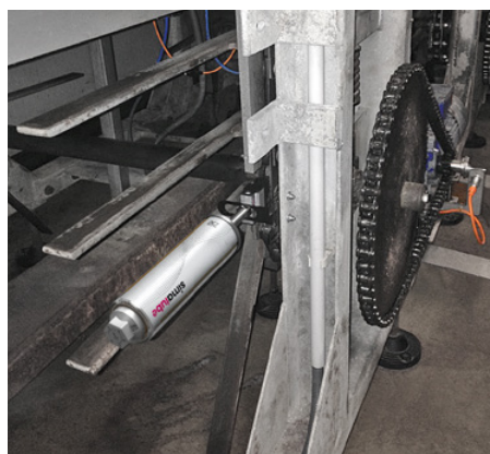
Kettenschmierung mit einem simalube 250 ml und einer Flachbürste.
