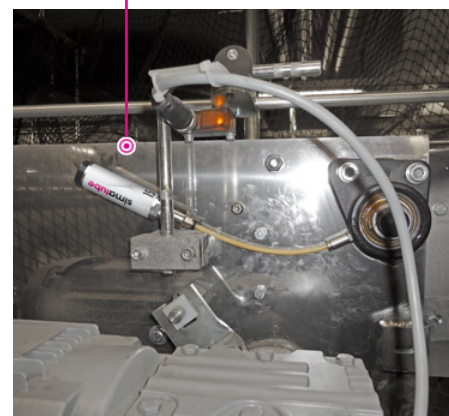
Flanschlager-Schmierung mit einem 15ml simalube, dem weltweit kleinsten Schmierstoffgeber.
